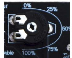
pas de délai : l'actionneur est allumé tant que le capteur est activé. Il reproduit exactement ce que renvoie le capteur, sans différence entre Redéclenchable et Non redéclenchable.
